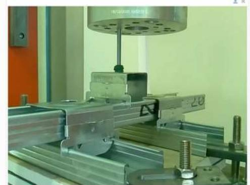
Disposición de ensayo: 24,50 Kg
