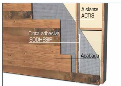
Respetar una cámara de aire de 20 mm como mínimo en cada una de las caras del aislante.
