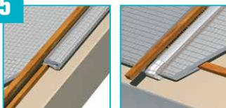
En el perímetro del aislamiento, para una estanqueidad perfecta, doblar el aislante hacia el interior sobre 50 mm mínimo y sellar con un rastrel o listón.
